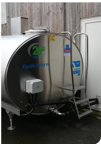
Avec le projet Tank 2020, Serap industries entend baisser de 80 % la consommation annuelle d'électricité dédiée au bloc Traite, diminuer les émissions de gaz à effet de serre et garantir la bonne préservation de qualité du lait tout en réduisant les coûts énergétiques. Ces différents paramètres sont en cours de tests grâce au dispositif automatique d'enregistrement des consommations d'énergie de la ferme de Derval, labellisée Digifermes.
