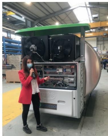
tourne que trois heures, soit juste le temps nécessaire pour abaisser la température du lait et favoriser sa conservation. Parallèlement, un échangeur à plaques récupère les calories du lait refroidi et produit de la chaleur pour chauffer de l'eau qui sera ensuite stockée dans un
