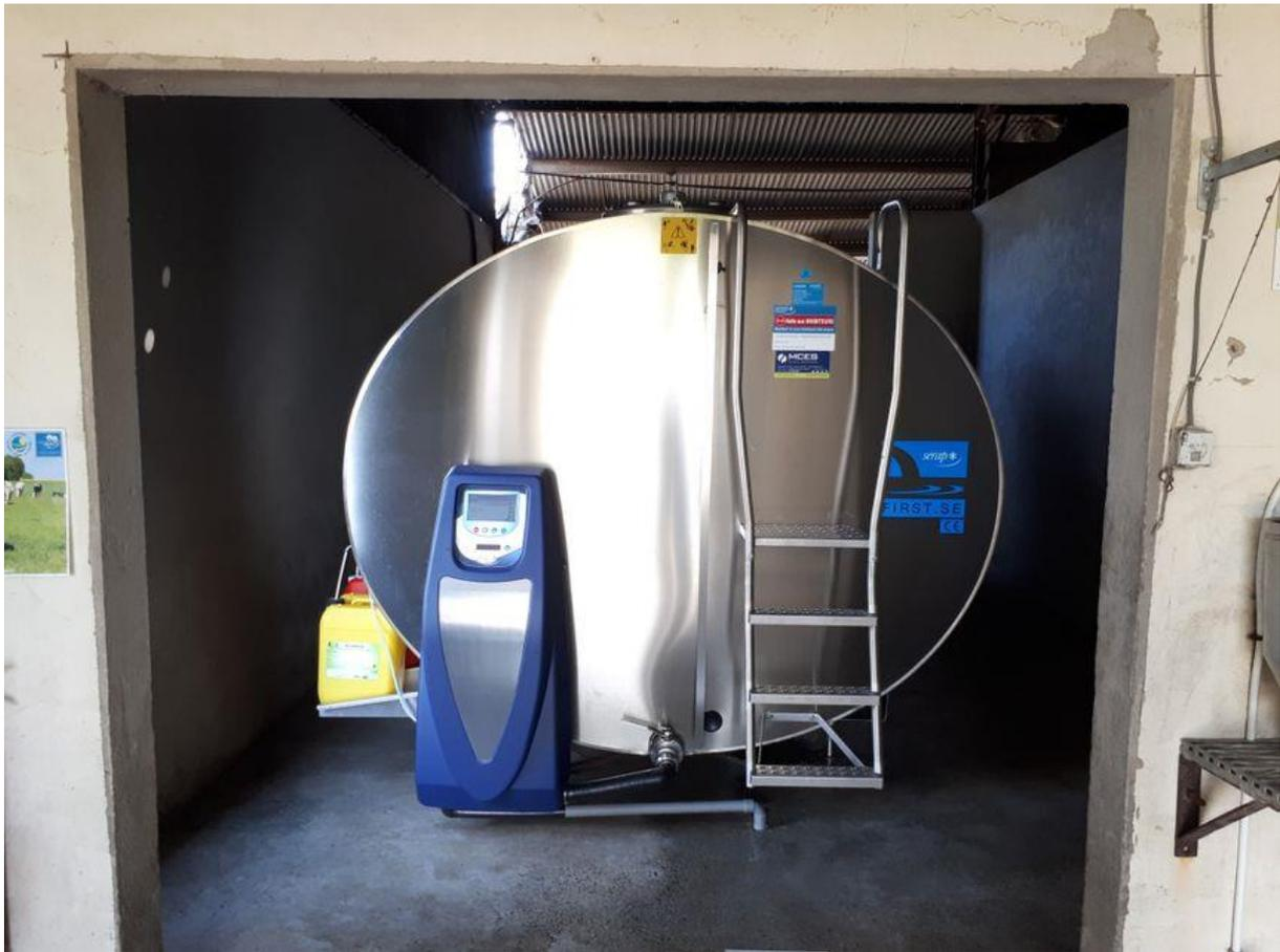
La cuve de refroidissement permet à Samuel Barrier, producteur en Mayenne, d'amener le lait à une température de conservation de quatre degrés. © Radio France - Théo Boscher
